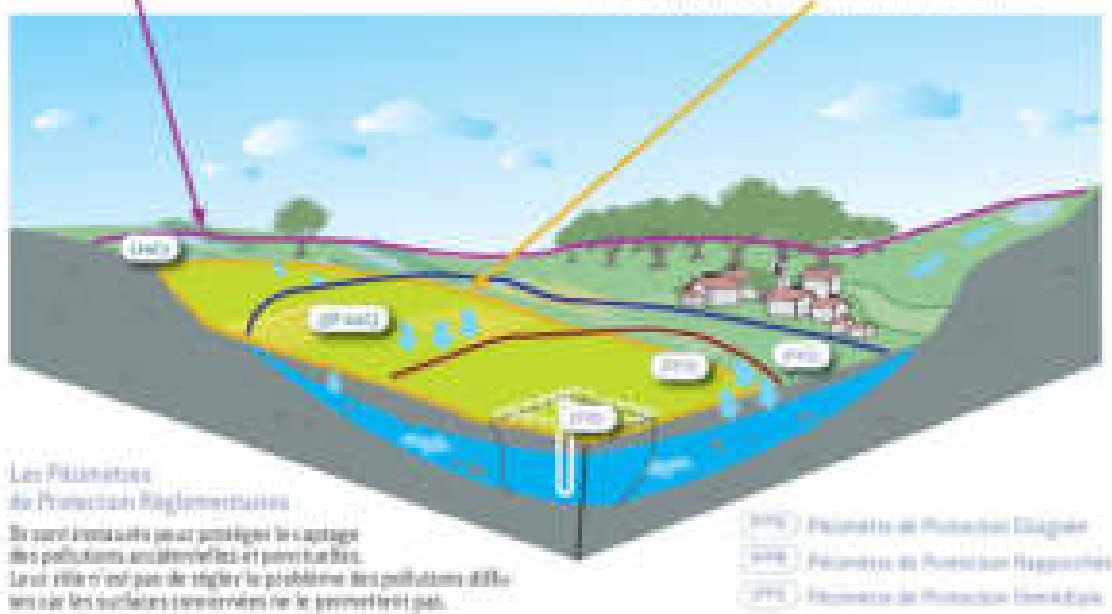
Figure 9: Échelles de protection d’un captage d’eau potable
